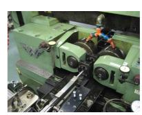
ロールダイスによる転造加工 Rolling process by Rolling dies
