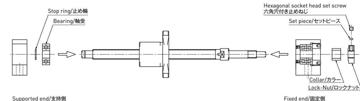
2. テーブルとボールねじナットの組付け及びユニットとベース取付け
