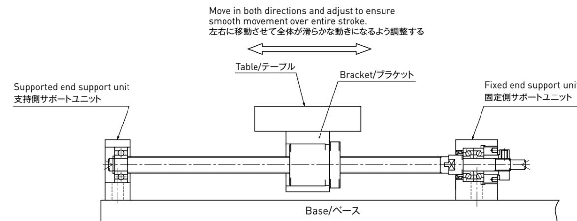
3. 支持側ハウジングとベースの取付け及び精度確認
