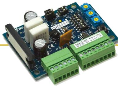
DC24V 0.25~1.5A / 相 0.25~1.5A / phase マイクロステップ Micro-step 基板タイプ Board type
