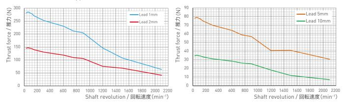
モータ型式 / Motor model: 14E2215 (□35) 対象アクチュエータ / Applicable Actuator: DMBR0801, DMBR0802, DMBR0805, DMBR0810
