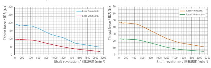
モータ型式 / Motor model: 11E2216 (□28) 対象アクチュエータ / Applicable Actuator: DMBR0504, DMBR0601, DMBR0602, DMBR0610
