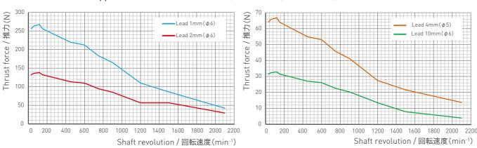
モータ型式 / Motor model: 14E2110 (□35) 対象アクチュエータ / Applicable Actuator: DMBR0801, DMBR0802, DMBR0805, DMBR0810
