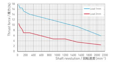
モータ型式 / Motor model: 11E2110 (□28) 対象アクチュエータ / Applicable Actuator: DMBR0504, DMBR0601, DMBR0602, DMBR0610
