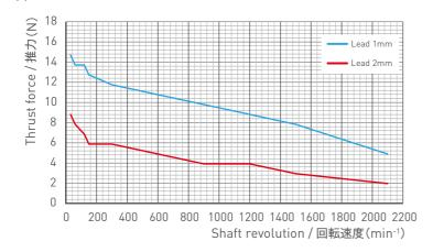
モータ型式 / Motor model: 08E2105 (□20) 対象アクチュエータ / Applicable Actuator: DMBR0401, DMBR0402
