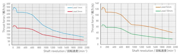
モータ型式 / Motor model: 17E2115 (□42) 対象アクチュエータ / Applicable Actuator: DMBR0801, DMBR0802, DMBR0805, DMBR0810
