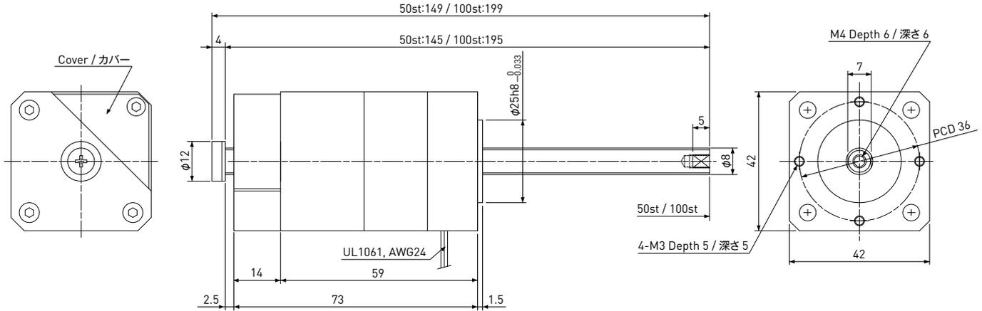
Motor lead wire /モータ線(310mm)
