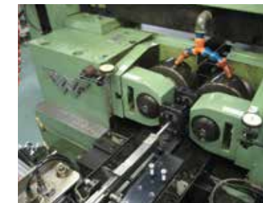
ロールダイスによる転造加工 Rolling process by Rolling dies
