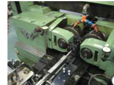
ロールダイスによる転造加工 Rolling process by Rolling dies
